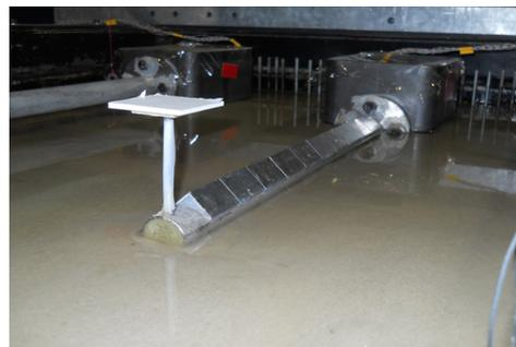
図-6 山形部材 (アングル) を取り付けた模型管路(Model D)
