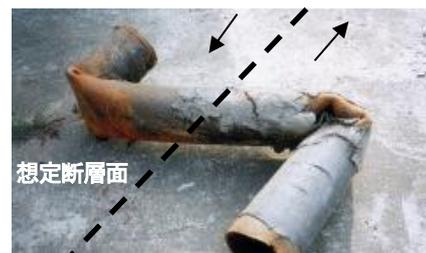
図-1 断層横断管路被害例(台湾集集地震)<sup>3)</sup>
