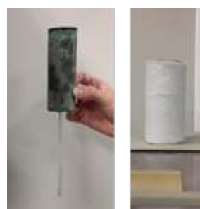
図-13 杭及び均等重量化模型とドレーン併用
