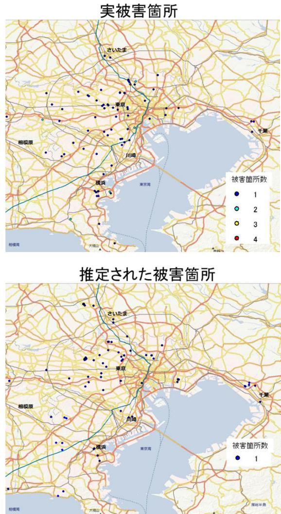
図-9 実被害箇所と推定された被害箇所の比較
