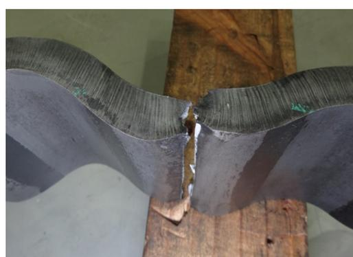
写真-6 破断面(RP-BRB-space-6, 波⑨)
