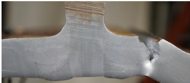
(f) 溶接部に切り欠き：破断
