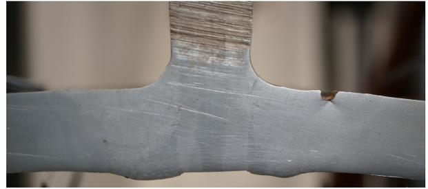
(b) 溶接部に切り欠き：き裂発生
