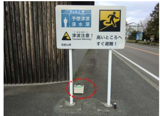
写真-1 常時微動計測状況の一例
