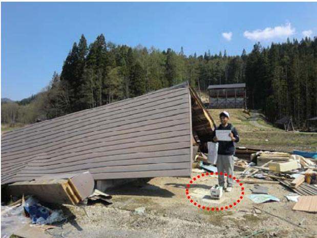
写真-1 常時微動計測状況の一例
