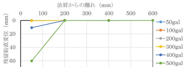
図-9 上載盛土表面の沈下量 (Case1)
