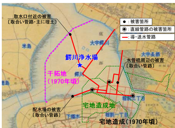
図-3 鹿行広域用水供給事業の場外管路の被害状況 19)
