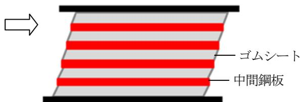
図-1 積層ゴム支承の構造
