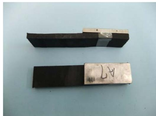
写真-3 90° はく離試験の試験片
