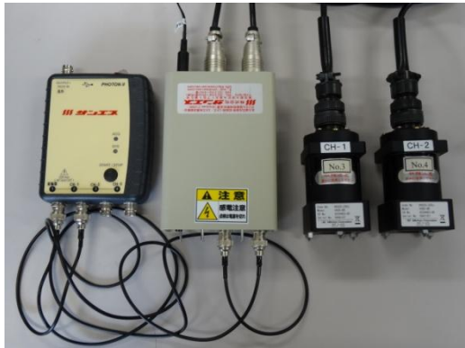
図-3 サーボ型加速度計，プリアンプ，リアルタイム音響振動解析装置
