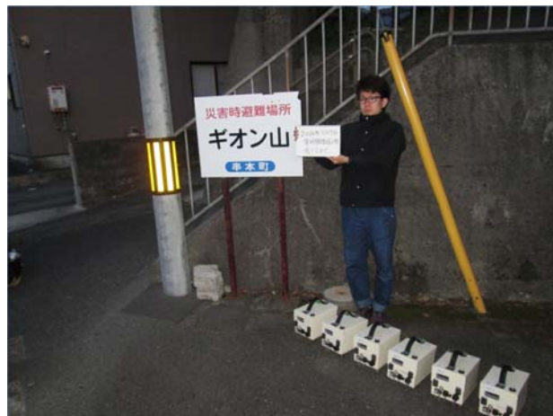
写真-2 常時微動計測に用いた6台の計測機器
