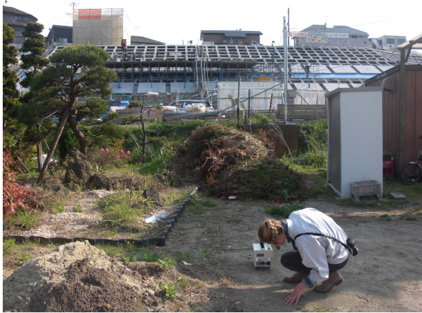
写真2 常時微動計測状況（法尻）
