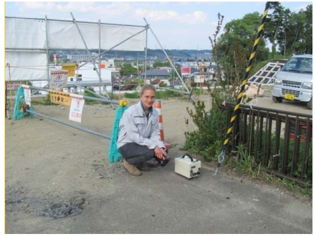
写真3 常時微動計測状況（法肩）
