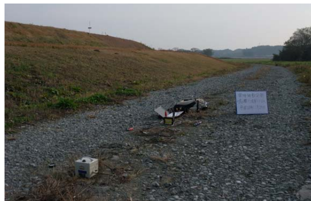
写真-1 鳴瀬川堤防沿いでの常時微動計測状況例(左岸11.0k)
