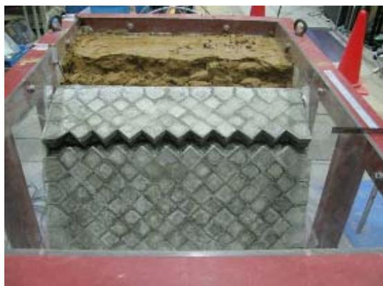
写真-5 留変形状況 (Case2,1000Gal) エラーブックマークが定義されていません。
