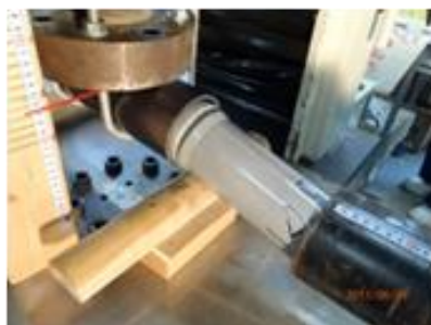
図-17 せん断耐力実験状況
