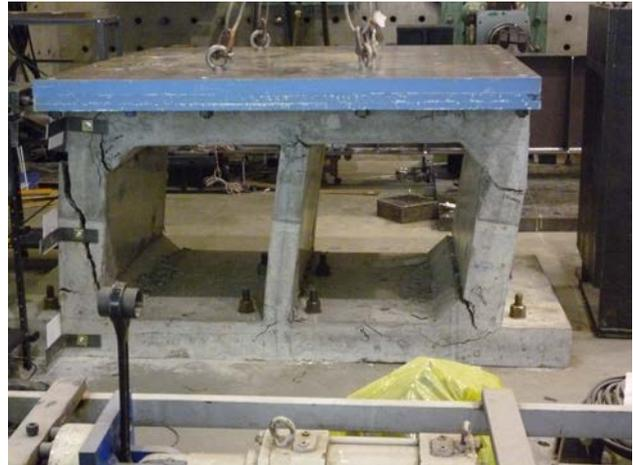
図-6 荷重終了時の損傷状況 (Case0)
