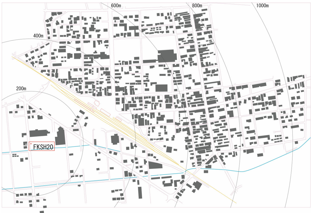
図-8 建物被害悉皆調査の対象とした地域と建物。同心円はFKSH20からの距離を表す。
