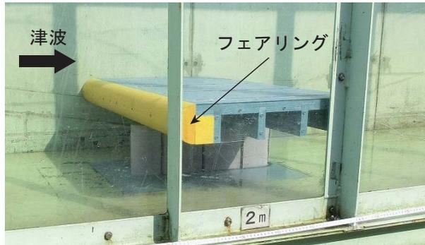
写真-1 半円フェアリングを取り付けた橋梁模型
