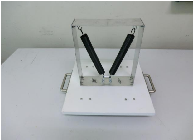
写真-6 耐震補強した建物模型
