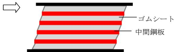
図-1 積層ゴム支承の構造
