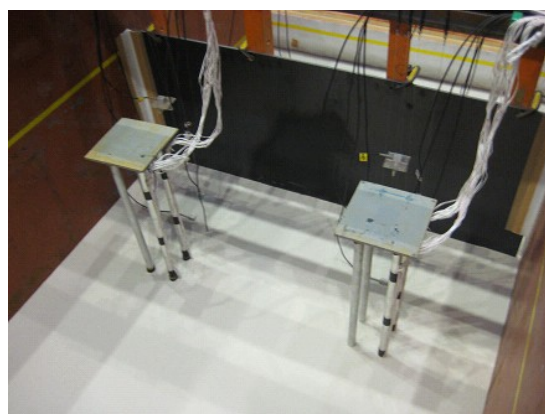
(c) 非液状化地盤作製完了（杭基礎周辺）
