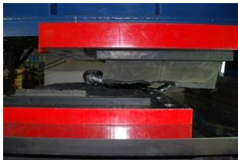
写真-4 破断状況（上：劣化，下：リファレンス）
