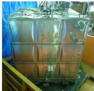
写真-1 実験に用いたステンレス製パネル式タンク
