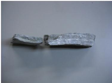
写真-1 用いた岩ズリの粒子形状
