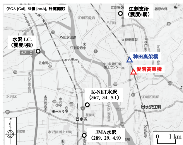
図-1 愛宕・稗田高架橋周辺における本震観測記録の分布
