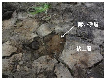
写真-19 堆積粘土層の下方に薄い砂層がある事例
