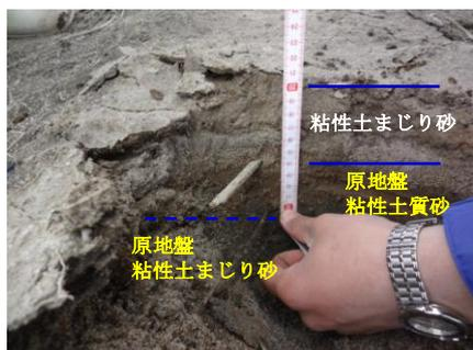
写真-17 原地盤の粘土層の下方に砂層がある事例
