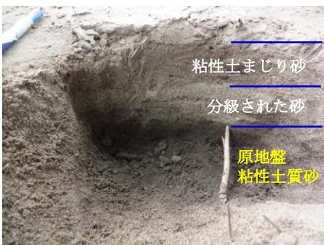
写真-2 堆積砂層内で堆積状況が異なる事例
