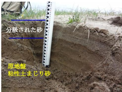
写真-8 砂質土の原地盤における砂の堆積の事例
