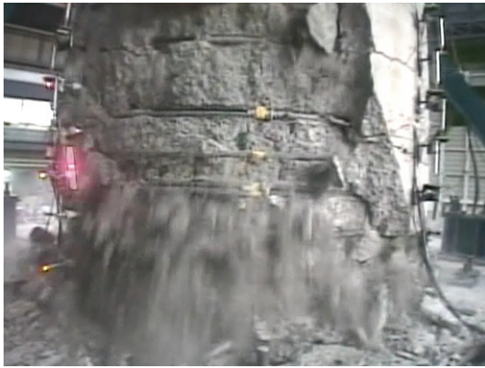
写真-1 コアコンクリートの破壊状況
