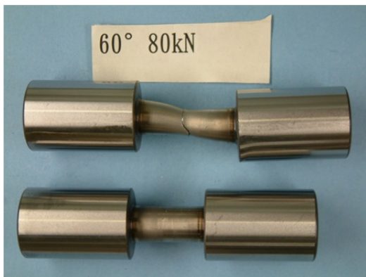
写真-4 ローラーの破断状況 (case3, 上面より撮影)
