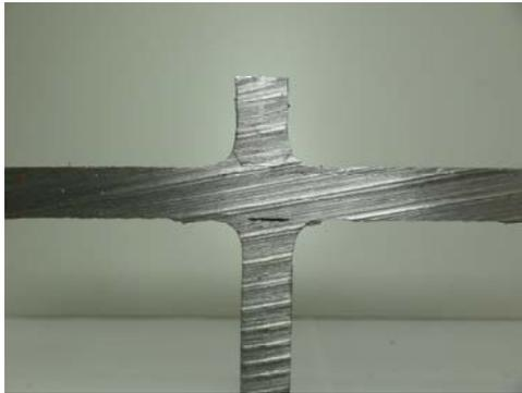
写真-3 十字継手の破壊状況
