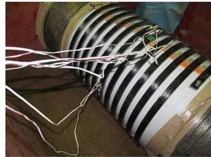
図-27 試験供試体 (コイル+PVC : 隙間 22.5mm)
