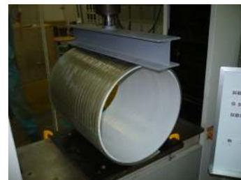
図-15 ライニング+高剛性部（隙間なし）
