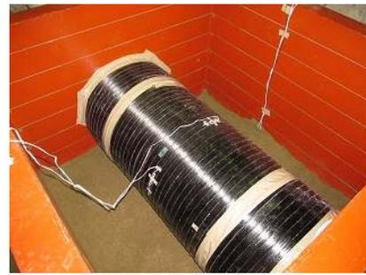
図-26 試験供試体 (コイル+PVC : 隙間なし)
