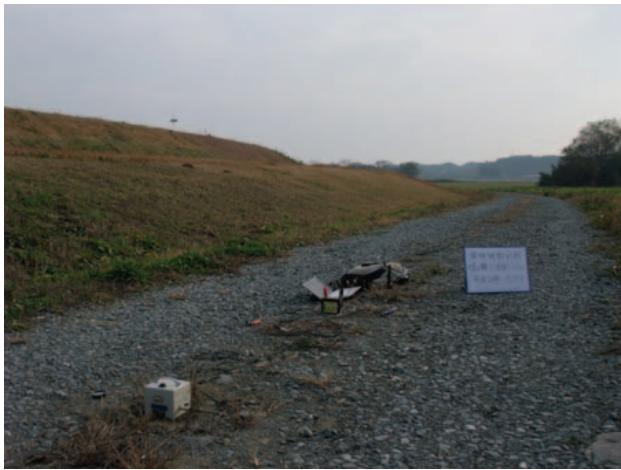
写真-1 鳴瀬川堤防沿いでの常時微動計測状況
