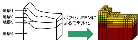
図-4 地形のボクセルメッシュによるモデル化
