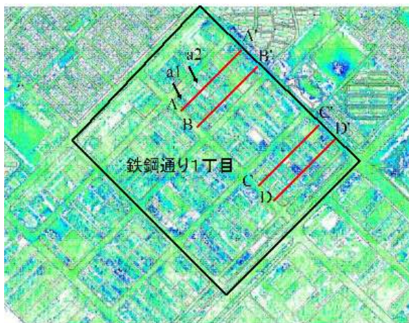
図-6b 鉄鋼通り1丁目の沈下の様子および測線位置
