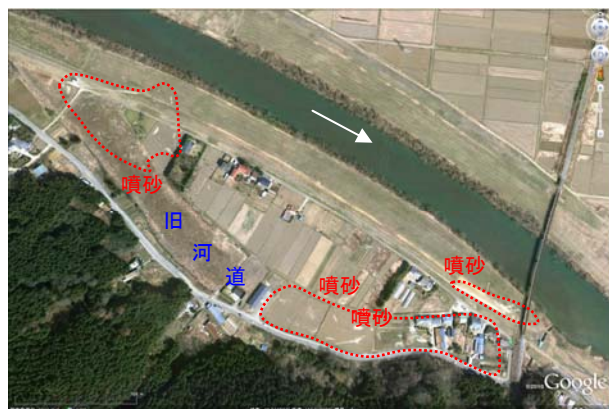
写真-8 江合川右岸西八反崎・北和渕の旧河道における噴砂 (2011/4/6 撮影 Google Earth 画像に加筆)
