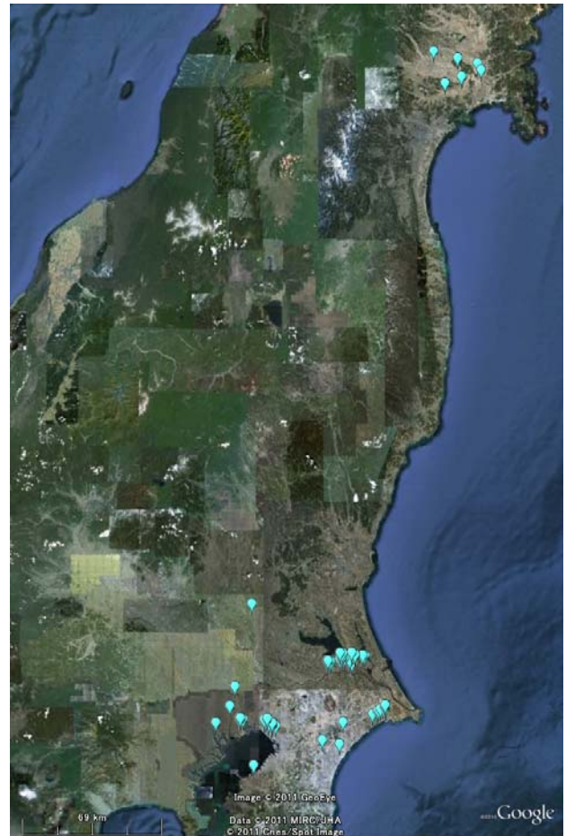
図-2 東北地方太平洋沖地震で再液状化が確認された地点（水色のアイコン）の分布（Google Earthを利用）
