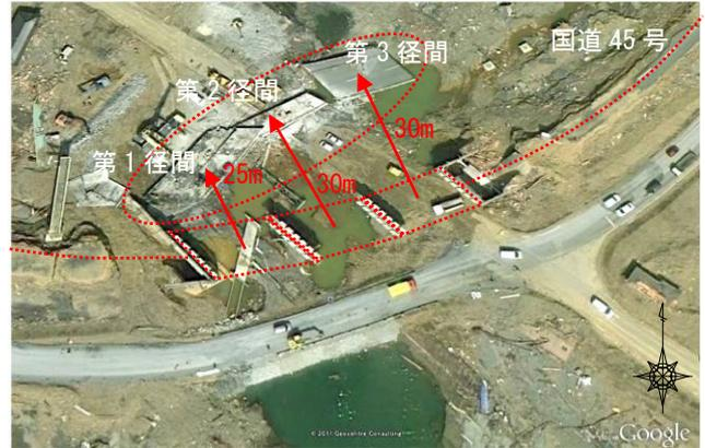
図-4 上部構造流失状況
