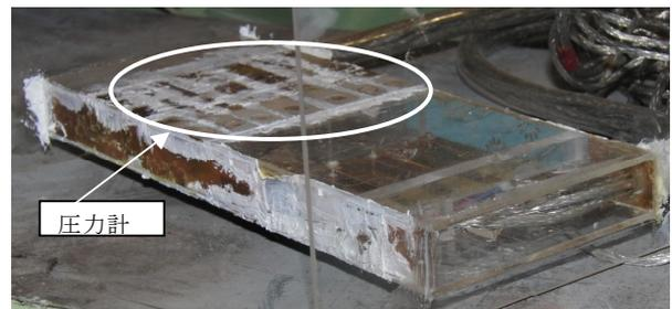
写真-1 圧力計を取り付けた模型
