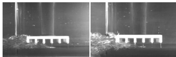
1) CASE5-3 (砕け寄せ波型) 2) CASE13-3 (巻き波型) i) 津波衝突時
