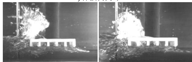
1) CASE5-3 (砕け寄せ波型) 2) CASE13-3 (巻き波型) ii) 水平力ピーク時
