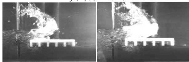
1) CASE2-3 (砕け寄せ波型) 2) CASE10-3 (巻き波型) iii) 鉛直力ピーク時 (a) 静水深45mm
