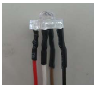
写真-3 ケーブルの絶縁処理を行った LED
