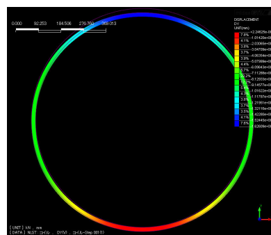
図-20 高剛性部解析結果 (9.58kN時16.2mm変形)
