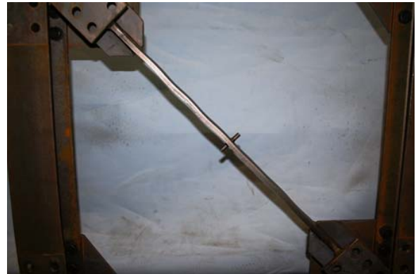
(b) 実験終了後のブレース材の変形状態(拘束材除去後)
