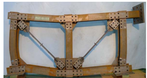
(b) 実験終了後のブレース材(拘束材除去後)
