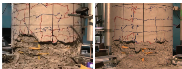
(a) S-1模型 (b) S-2模型 写真-7 5回目加震後の損傷状況 (SW面)
