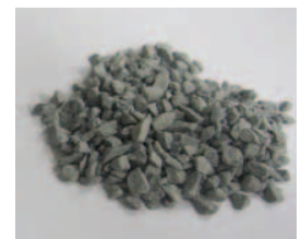
(a) 13mm (b) 5mm 写真-3 縮小模型に用いた粗骨材の寸法
