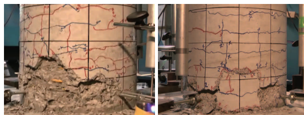
(a) S-1模型 (b) S-2模型 写真-6 4回目加震後の損傷状況 (SW面)
