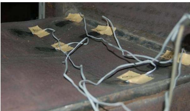
写真-2 フランジ部分での座屈 (1.8δ<sub>y</sub>)
