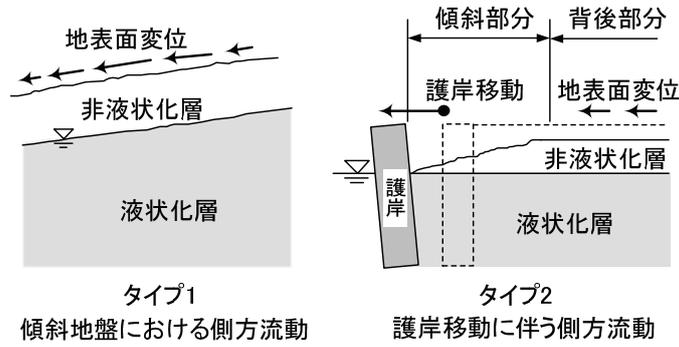
図-2 液状化に伴う流動の発生する地盤条件<sup>3)</sup>
