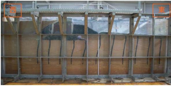
写真-2 アクリル壁面から見た色砂の変形状況 (傾斜あり断面)
