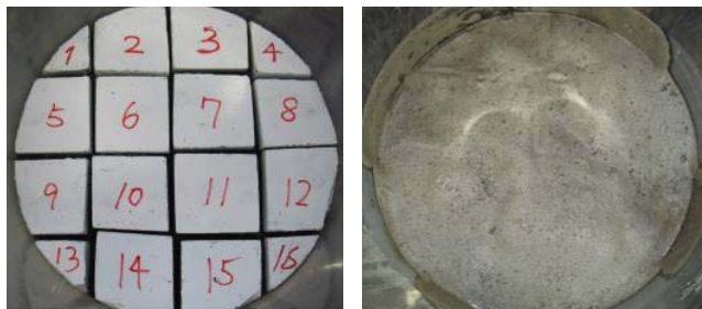
図-11 浦安砂の試験前・後の状況
