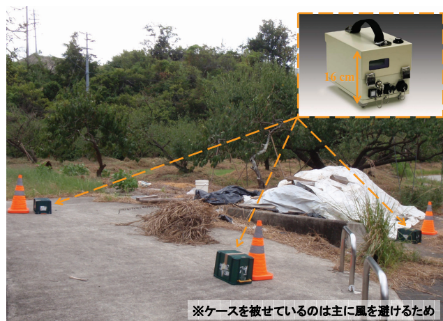
写真-4 微動アレー探査実施状況と採用した微動計
