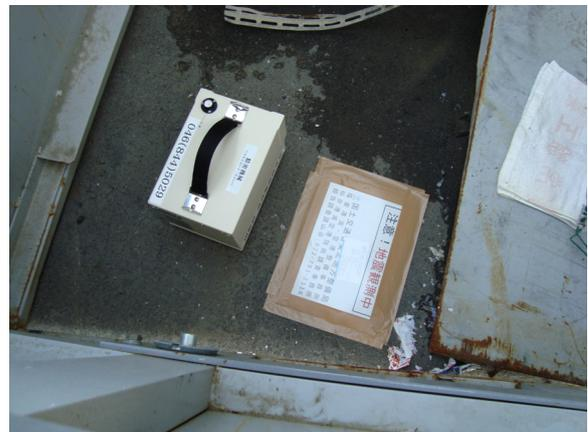
写真-4 余震観測を実施した場所と地震計の設置状況
