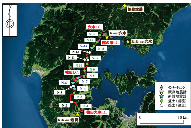
図-13 能登有料道路盛土法尻における常時微動計測位置
